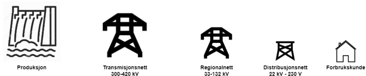
Figur 1: Figuren viser oppbyggingen av det norske strømmettet. Større kraftverk er som regel tilknyttet transmisjonsnettets og de fleste forbrukere er tilknyttet distribusjonsnettets.
