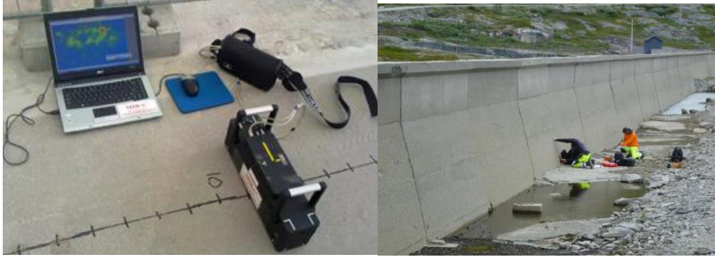
Figur 7 Geoelektrisk tomografi på Iptodammen, forsøk 2015-2016.
