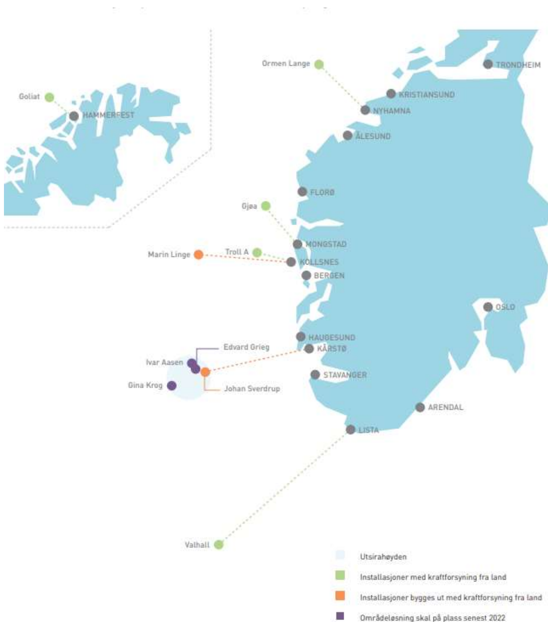
Figur 4-3: Oversikt over installasjoner på norsk sokkel som får kraftforsyning fra land. Kilde KonKraft
